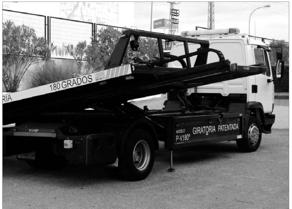
Primera grúa patentada capaz de girar 180 grados, creada por Liderkit Group.
